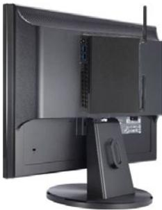
Dank der mitgelieferten VESA-Befestigung können Sie den Recorder platzsparend direkt hinter dem Monitor befestigen, sofern dieser für die Montage mittels VESA Standard ausgelegt ist.
